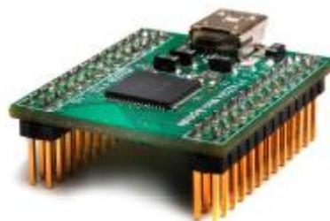
**Figure 4: FTDI FT4232 Mini module<sup>1</sup>**
